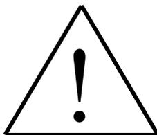
Места, там, где расположены электро-элементы, обозначены символом 131 по DIN 30 600.
